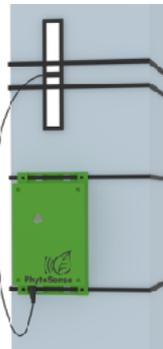
Connectez l'antenne au boîtier émetteur. Si la réception cellulaire est mauvaise sur le lieu d'installation, l'antenne doit être placée plus haut dans la serre (par exemple, au-dessus de la culture) ou être éloignée des objets métalliques qui pourraient interférer avec la réception cellulaire.
