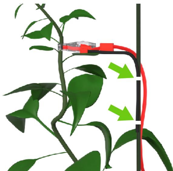
Fixez le fil de positionnement au support (par exemple à l'aide de colliers de serrage).
